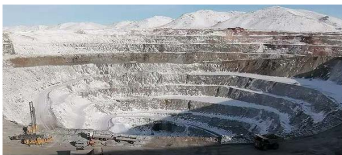
Месторождение полиметаллических руд Акбастау – область Абай, Аягозский район, в 36 км северо-западнее поселка Корык На 01 января 2023 года балансовые запасы – 6.2 млн. тонн с содержанием меди 2.37% Рудник подземный: Акбастау
