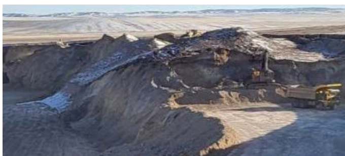
Месторождение медных руд Хаджиконган – Карагандинская область, Бухар-Жырауский район, в 12 км юго-западнее села Шешенкара На 01 января 2023 года балансовые запасы – 4.5 млн. тонн с содержанием меди 1.86% Рудник открытый: Хаджиконган
